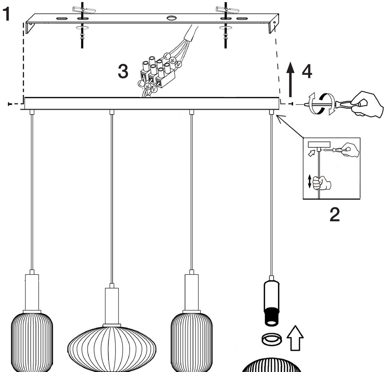
Ajustar la longitud de los cables antes de instalar. Colocar las tulipas una vez instalada la lámpara en su lugar definitivo.
